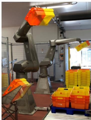
Grâce à leurs 6 axes de liberté, les **robots poly-articulés** sont très polyvalents. Ils se déclinent en une large gamme (allant du robot collaboratif au gros porteur) et répondent à de multiples applications de manipulation ou de process.
