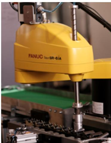
Les robots **SCARA** sont majoritairement utilisés pour des applications de «**pick and place**» acceptant des cadences élevées. La manipulation de pièces se fait sur un plan en raison de leur enveloppe de travail cylindrique.
