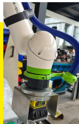
*Automatisation de contrôles qualité effectué à l'aide d'un robot collaboratif équipé d'un système de vision embarquée.*
